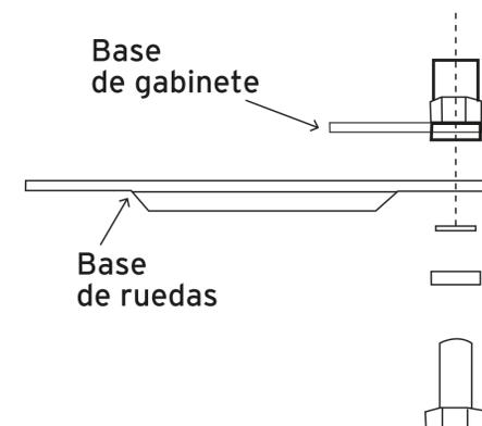
4.- En el lado opuesto del que haya colocado las ruedas fijas ahora coloque las ruedas giratorias y fíjelas con los tornillos, arandelas planas y las arandelas de seguridad que vienen incluidas. (Fig. 5)
